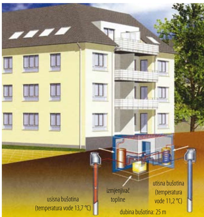
Ilustracija 12 Shema dizalica topline voda - voda u naselju Niehler WohnArt u Kölnu
