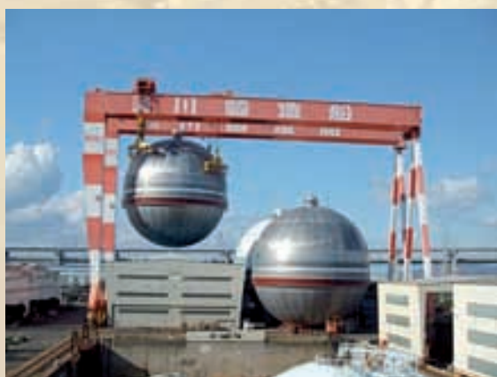
Ilustracija 6 Sferni spremnici za LNG (Mossov sustav)
