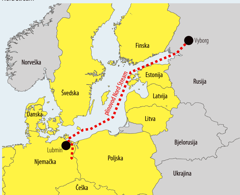
Ilustracija 1 Trasa plinovoda Nord Stream
