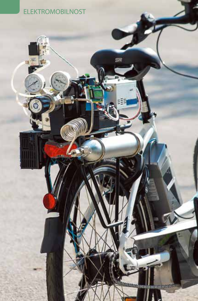
Pogled izbliza na sustav gorivnih članaka na nosaču za prtljagu i njegovi sastavni dijelovi...
